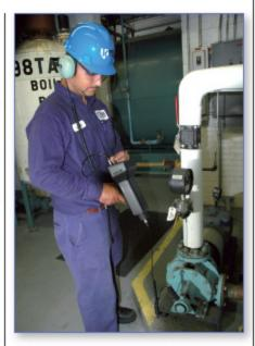
Obr. 2: Ultraprobe 10 000 s magnetickým kontaktním modulem
